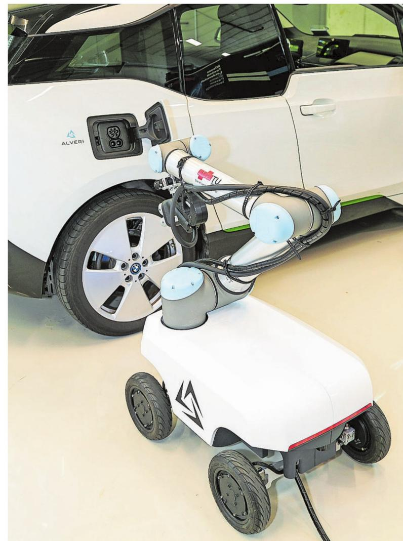
Es kommt auf Millimeter an: Der Laderoboter findet flott den Anschluss.
