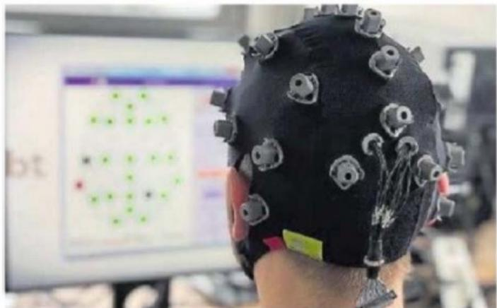
Dieses Hirnstrom-Messgerät erkennt frühzeitig eine Demenz
